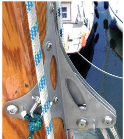
Der fertige Beschlag mit Anschlagpunkt für Vorstag und Umlenkrolle fürs Fockfall montiert am Mast der PLANAR
