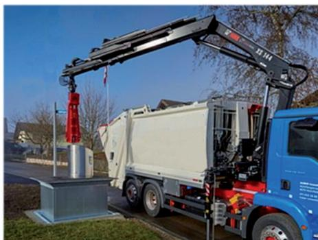
Für die Entleerung wird jeder einzelne Sammelbehälter mitsamt Einwurfrichter aus der Grube gehoben und in den LKW entleert. So ähnlich funktionieren zum Beispiel auch schon die Glassammelcontainer.
